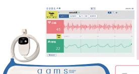
センサーマットから感知される心拍、呼吸、 体動の生体情報をサーバーを通して モニターに表示します。
